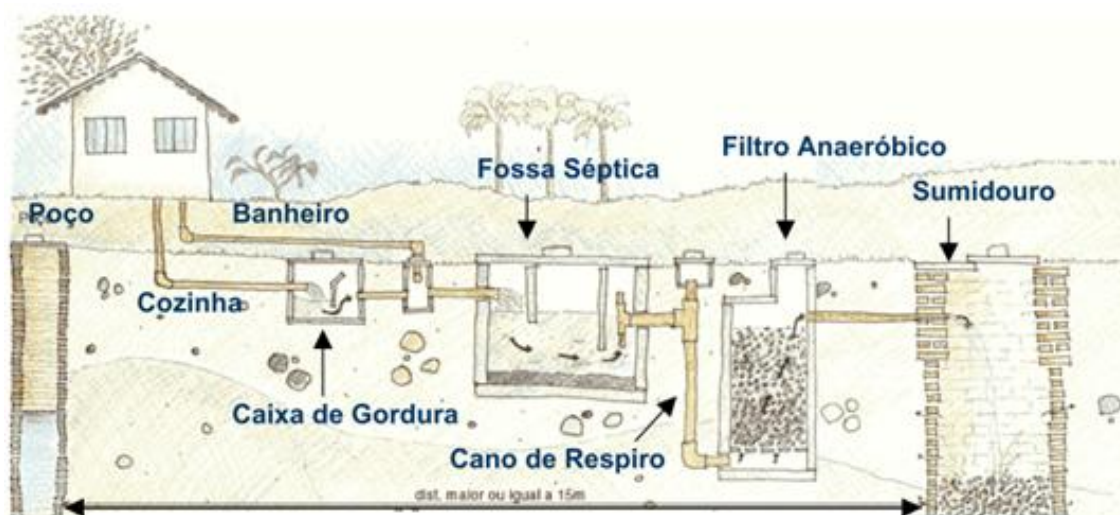
Figura 51: Alternativa para o sistema simplificado de esgotamento sanitário.
