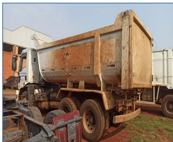
IMAGENS DA PARTE DE TRÁS DO CAMINHÃO BASCULANTE, ONDE JÁ PODEMOS VER SEU DESALINHAMENTO
