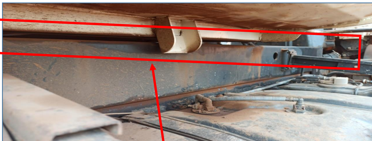
IMAGEM DETALHADA DO DESALINHAMENTO CITADO NA FOTO ACIMA DO LADO ESQUERDO (LADO DO MOTORISTA), JÁ NA FOTO ABAIXO PODEMOS VER O LADO OPOSTO ONDE HÁ UMA ABERTURA MÍNIMA ENTRE O CHASSIS E A CAÇAMBA BASCULANTE
