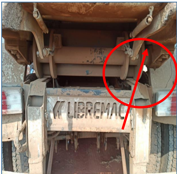
IMAGEM DA PARTE TRSEIRA DO CAMINHÃO BASCULANTE, PODEMOS VER CLARAMENTE O SEU DESALINHAMENTO
