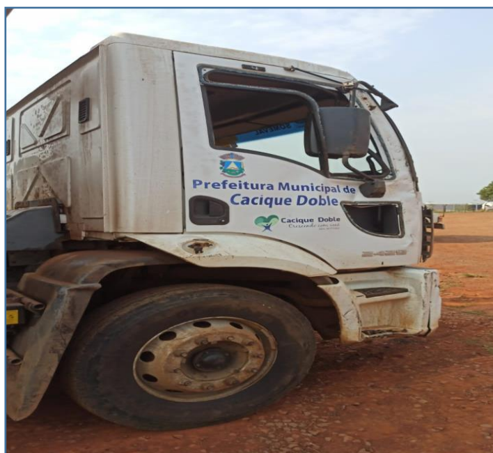
IMAGEM DA LATERAL DO CAMINHÃO BASCULANTE QUE FICOU MAIS DANIFICADA A LATARIA
