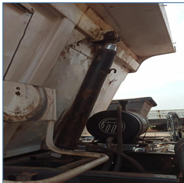
IMAGEM DO PISTÃO HIDRÁULICO, O MESMO AINDA NÃO PODE SER AVALIADO DETALHADAMENTE SOMENTE APÓS A SUA DESMONTAGEM PODEREMOS VER SE POSSUI ALGUM DANO
