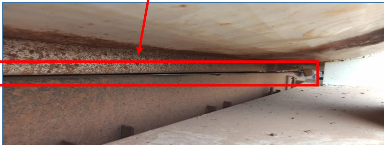
IMAGEM DETALHADA DO DESALINHAMENTO CITADO NA FOTO ACIMA DO LADO ESQUERDO (LADO DO MOTORISTA), JÁ NA FOTO ABAIXO PODEMOS VER O LADO OPOSTO ONDE HÁ UMA ABERTURA MÍNIMA ENTRE O CHASSIS E A CAÇAMBA BASCULANTE
