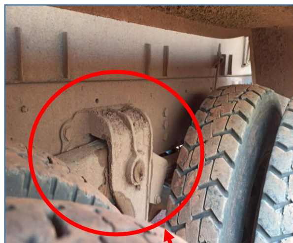
IMAGEM DE UM DOS BALANCINS DO CAMINHÃO BASCULANTE, AMBOS FICARAM DANIFICADOS
