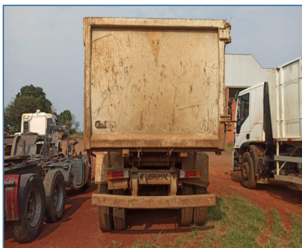
IMAGENS DA PARTE DE TRÁS DO CAMINHÃO BASCULANTE, ONDE JÁ PODEMOS VER SEU DESALINHAMENTO
